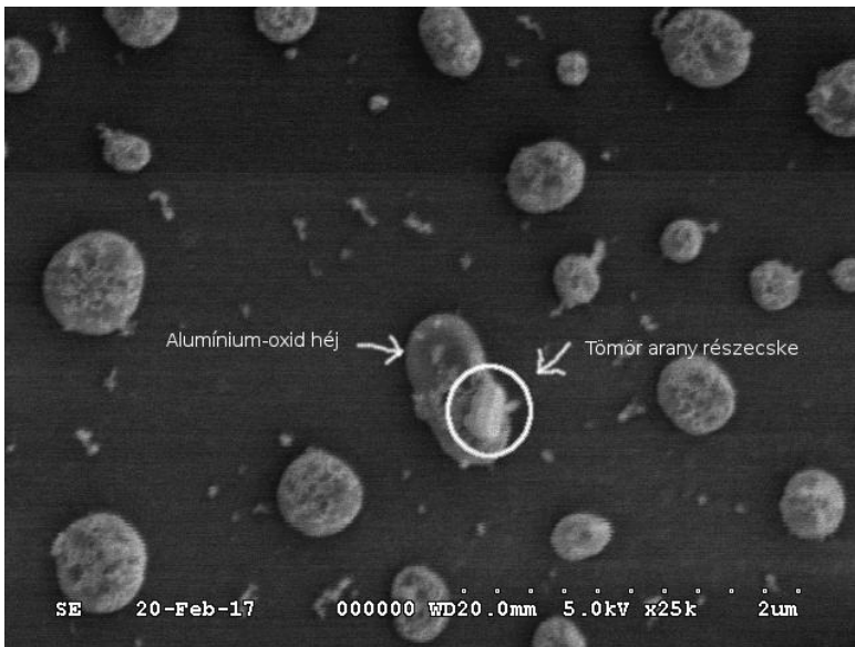
9. ábra Magas hőmérsékleten hőkezelt alumínium-oxiddal bevont arany nanorészecskék
